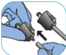
**ÉTAPE 3 :** Connectez la cartouche de thérapie SNAP™ au raccord à l'aide des deux mains. Pour activer la cartouche SNAP™, appuyez sur la clé d'activation/réinitialisation afin de la libérer et pouvoir la retirer de la cartouche SNAP™. Il peut être nécessaire de répéter cette opération à plusieurs reprises en fonction de la taille du pansement.
