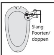
1. Sluit de PREVENA PLUS™ connector aan op de opvangbeker door de connector aan het einde van de slang te verbinden met de slangpoorten aan de zijkant van de opvangbeker. Druk de onderdelen stevig op elkaar.
