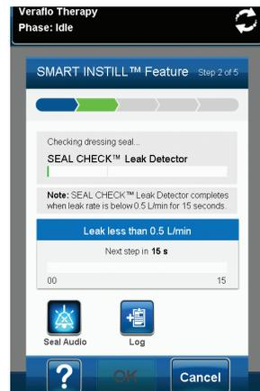
Vérification de l'étanchéité automatisée
